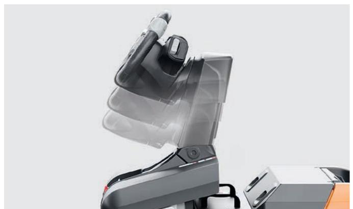
Óptima ergonomía gracias al volante ajustable en altura y ligeramente inclinado, que se adapta a las preferencias individuales de cada conductor
