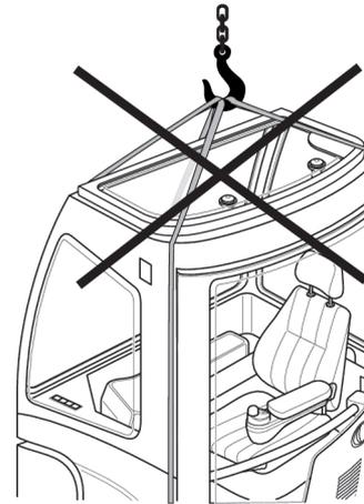
Figura 34. Elevación incorrecta
