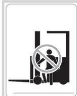
No se coloque entre el mástil y la batería
