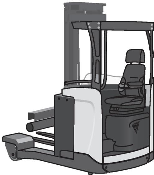
UFW Tergo (U\*\* Tergo) es una carretilla eléctrica cuatro caminos, adaptada especialmente para la manipulación de cargas largas y a granel y distintos tipos de portadores de carga. Se puede conducir en cuatro direcciones gracias a la rotación de la rueda de carga. La carretilla funciona con el portador de carga situado delante de las patas de apoyo y con el mástil retraído cuando el ancho del pasadizo es mínimo. Esta carretilla puede utilizarse para el apilamiento en diferentes
